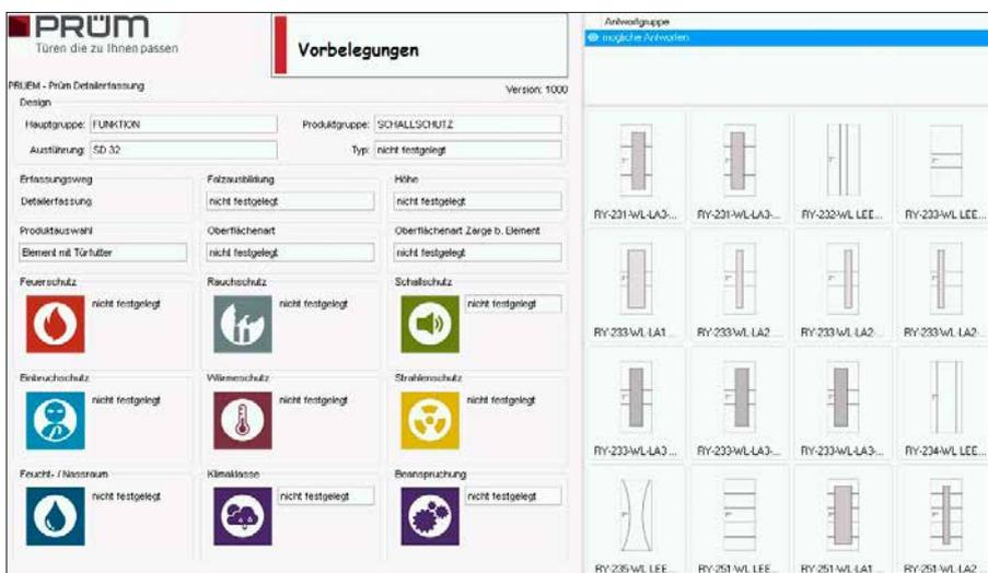
Erfolgt z.B. eine Festlegung im Merkmal „Schallschutz“ auf die Ausprägung „SK 2“, so sind in den Merkmalen „Wärmeschutz“ und „Strahlenschutz“ keine Eigenschaften mehr wählbar, in den anderen Merkmalen jedoch noch Auswahlen möglich.
